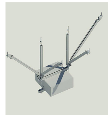
矩形风管侧重双向支撑 (T+L)
